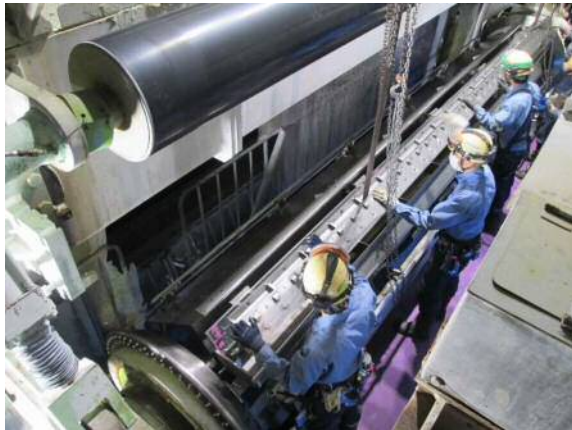
製紙工場のプレスロール 内部整備作業
