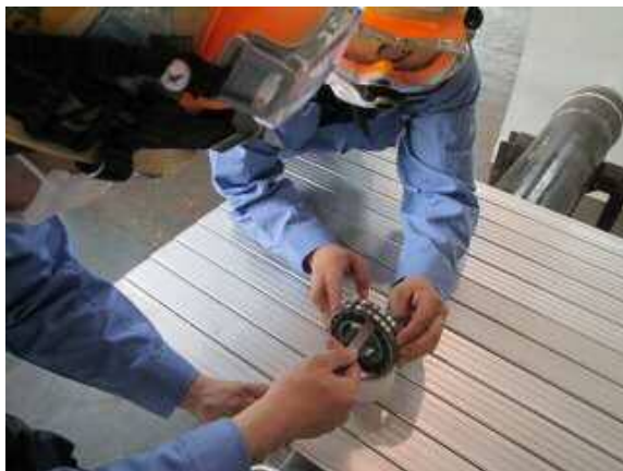
ベアリング フリー隙間の測定
