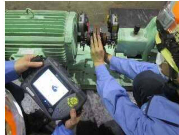
軸アライメント 調整作業
